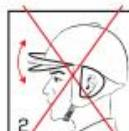
IL CASCO NON DEVE ESSERE ALLENTATO. NON VANNNO ACCETTATI TI ECESSIVI MOVIMENTI IN AVANTIE INDietRO PER LA MASSIMA PROTEZIONE. QUESTO CASCO DEVE COPRIRE IL PIÙ POSSIBILE LA FRONTE SENZA RIDURRE IL CAMPO VISIVO. SE MONTATO CORRETTAMENTE, NON Dovrebbe ESSERE POSSIBILE RUOTARE O SPOSTARE IL CASCO SULLA TESTA IN MODO DA RIDURRE IL LIVELLO DI PROTEZIONE E/O IL CAMPO VISIVO. VEDI IMMAGINE NO. 2
