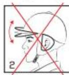
PRZESUWANIE KASKU NA GŁOWĘ W SPOSÓB ZMINIERSZAJĄCY POZIOM OCHRONY LUB POLE WIDZENIA. PATRZ RYS. 2
