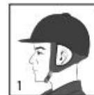
CHOICE OF RIGHT SIZE AND PROPER FITTING, TO MAKE SURE THE HELMET IN RIGHT POSITION. THE BUCKLE SHOULD BE POSITIONED FLAT ON THE SIDE OF THE FACE OR UNDER THE CHIN AND THE RETENTION SYSTEM SECURELY ADJUSTED TO BE BOTH COMFORTABLE AND FIRM. SEE NO.1
