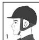
WÄHLEN SIE DIE PASSENDE GRÖSSE UND SETZEN SIE DEN HELM RICHTIG AUF DEN KOPF STELLEN SIE SICHER, DASS DER HELM IN DER RICHTIGEN POSITION SITZT. DIE SCHNALLE SOLLTE FLACH AUF EINER SEITE DES GEsICHTS ODER UNTER DEM KINN LIEGEN UND DAS BEFESTIGUNGSSYSTEM SOLLTE SO EINGESTELLT SEIN, DASS ES SOWOHL BEQUEM ALS AUCH SICHER IST. SIEHE NR. 1
