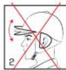
No se lo ponga con flojera, ni hacia delante ni detrás. Para una máxima protección, este casco debe cubrir la mayor parte posible de la frente sin reducir el campo de visión. Cuando se ajuste correctamente, no debería ser posible girar o mover el casco sobre la cabeza de manera que se reduzca el nivel de protección y/o el campo de visión. Véase 2.
